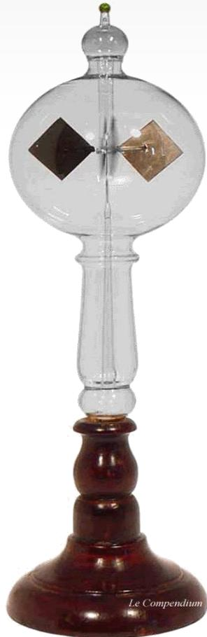
Radiomètre à air
